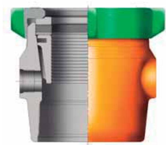
CABEZA COLGADORA DE REVESTIMIENTO ROSCA SUPERIOR 11.3/4"
